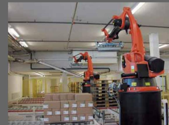
Impianto realizzato per HACO: impianto di palletizzazione per scatole con robot kuka
