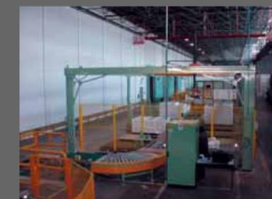
Impianto realizzato per ELETTRORLUX ZANUSSI: impianto di palletizzazione per piani di cottura
