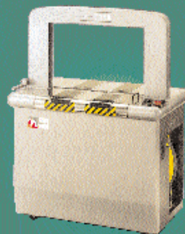
711A Reggiatrice automatica dotata di tappeti motorizzati e fotocellule per lettura pacco.
