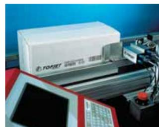
Collegabile alle più diffuse linee di produzione, HR Printer può essere controllata da sistemi di supervisione con possibilità di collegamenti multidrop. Inoltre è dotata di software di gestione per la stampa grafica, testuale e dei più comuni codici a barre: EAN-13, UPC-A, CODE 128, EAN 128, 2/5 interleaved. Il sistema prevede la possibilità di manipolare i dati di stampa attraverso espansione verticale e orizzontale, stampa da sinistra a destra e viceversa e stampa rovescio.
