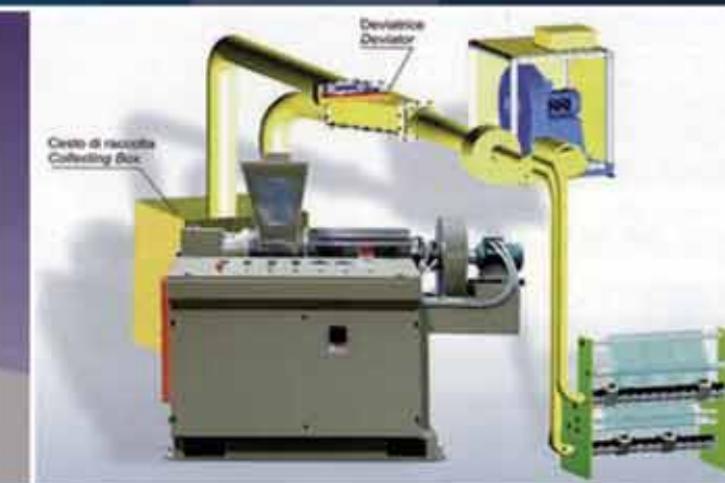
estrusore per recupero rifili da linee blow film
