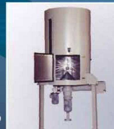
silo di stoccaggio alimentazione fluff in linea
