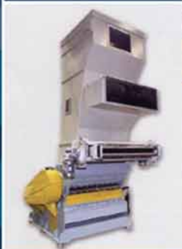
mulino per film-linee: cast e blow film con traino recupero bobine
