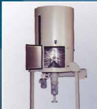
silo di stoccaggio alimentazione fluff in linea
