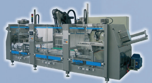
Isola di carico monoblocco
